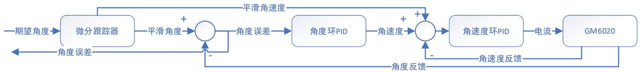
图 10 云台电机控制模块
